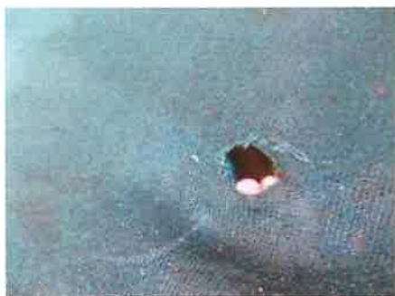
3) Poškozená krycí plachta
